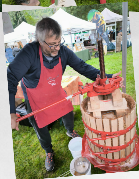
3. Passage des pommes dans le broyeur, puis dans le presseur pour obtenir le jus de pommes
